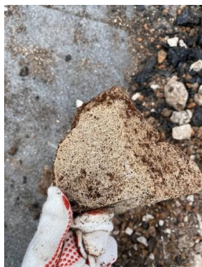
Рисунок 2 – Склад покриття із включеннями газобетону
