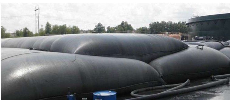
Рисунок 5 – Зневоднення та зберігання річкового мулу (донних відкладень) у геотубах.
