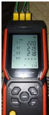
Рисунок 2 - Реєстратор температури поверхні стіни
