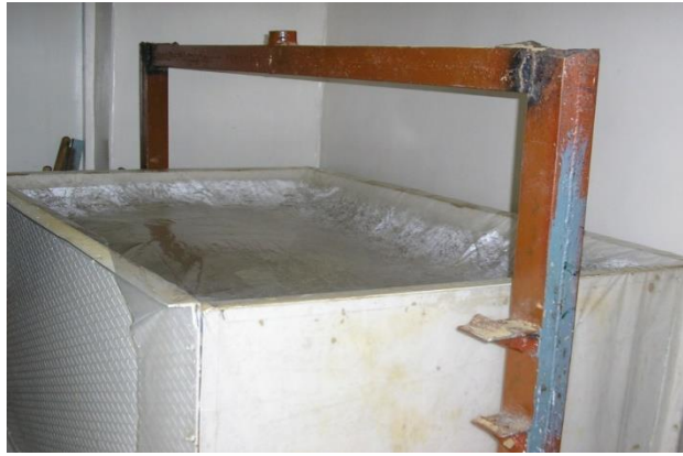
Рисунок 1 – Лоток з ущільненим піском, накритий поліетиленою плівкою для збереження вологості
