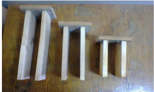
Рисунок 3 – Моделі двощілинного фундаменту при низькому ростверку з довжиною щілин: а) 400 мм; б) 300 мм; в) 200 мм
