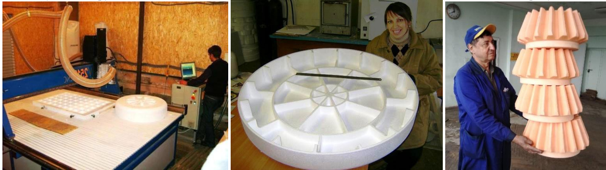
Рисунок 6 – Ливарні разові моделі з ППС, виготовленні у ФТІМС НАНУ за 3D-технологіями.
