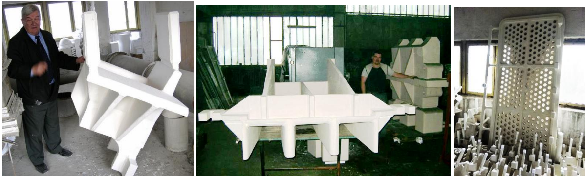
Рисунок 5 – Крупні моделі з ППС, за якими ливарниками ФТІМС НАНУ було виготовлено металопродукцію.
