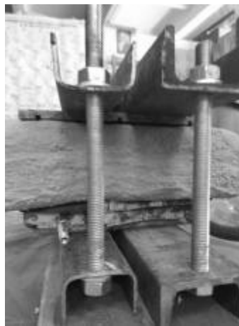
Рисунок 3 – Фіксація спеціально розробленого «лоточка» до нижньої поверхні залізобетонного зразка за допомогою систем затяжок
