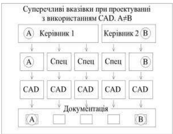
Рисунок 5 – Наслідки суперечливих команд при CAD-проектуванні
