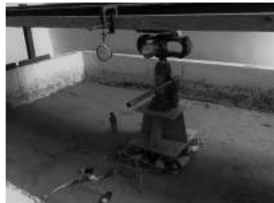
Рисунок 3 – Фізична модель ростверку 290 мм × 290 мм під час випробувань
