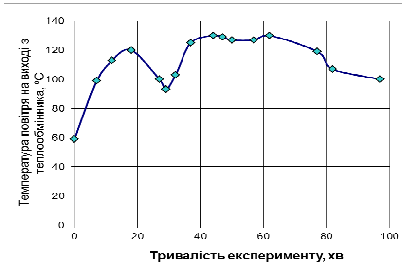
Рисунок 1 – Зміна температур повітря на протязі експерименту при запуску котла з холодного стану
