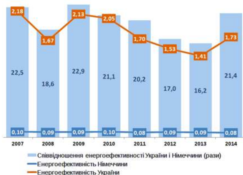
Рис. 1. Енергоємність (кг нафтового еквіваленту/дол) і співвідношення енергоємності (рази) України і Німеччини в 2007 – 2014 роках[3]
