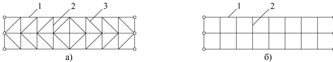
Рисунок 2 – Схеми суміжних граней верхньої зони прямокутної в плані сітчастої оболонки: а – початкова; б – оптимізована; 1, 2, 3 – поздовжні, поперечні і діагональні стержні; о – опорні вузли
