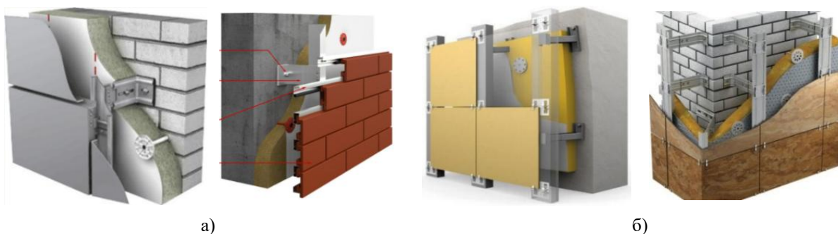
Рисунок 2 – Конструктивно-технологічна схема навісних вентиляованих фасадів:
